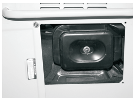
Figura 9 - Schimbarea filtrului de aer
