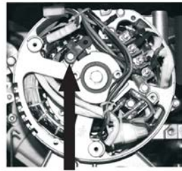
Figura D - Posizione delle spazzole di carbone. Alla fine, questo elemento potrebbe dover essere sostituito quando si usura.
